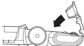
**4** Pour assembler de nouveau, remplacez la base en l'alignant le long du devant de la buse. Pivotez pour fixer en place et remettez les trois verrous.
