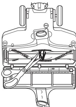
**3** Retirez les cheveux, les fibres ou les débris enroulés autour de la brosse rotative. La pièce rotative comporte une rainure où l'on peut glisser des ciseaux afin de couper et de dégager les débris accumulés.
