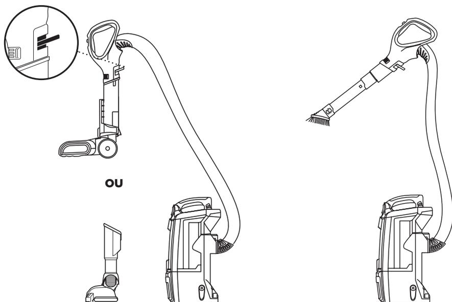
**2** Insérez la poignée dans la buse de plancher motorisée ou l'accessoire Dust-Away<sup>MC</sup> Pro. Vous disposez maintenant d'un outil pratique pour nettoyer les escaliers.
