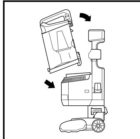
Para reinstalar, coloque la parte inferior del recipiente para el polvo en el receptáculo y luego inclínelo hasta que encaje en su lugar.
