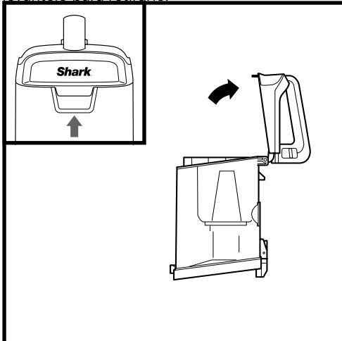
Para retirar los escombros recolectados de la **pantalla de pelusa**, levante la lengüeta en la parte superior del recipiente para el polvo para abrir la tapa. Retire los escombros de la pantalla de pelusa para limpiar.
