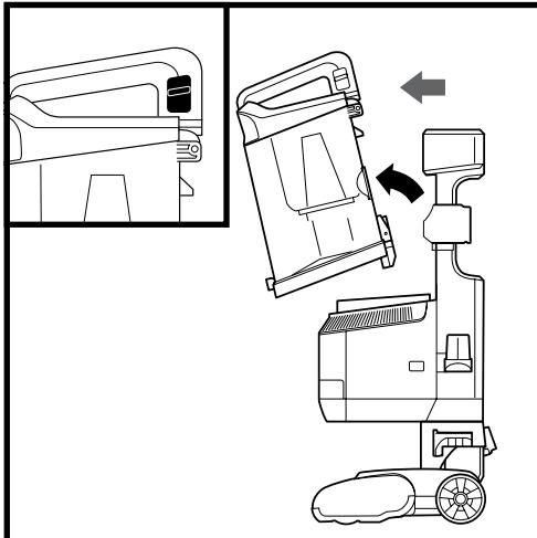
Para retirar el **recipiente para el polvo**, levante el botón de liberación localizado en el costado del mango del recipiente para el polvo. Incline el recipiente para el polvo hacia adelante, luego levántelo para retirarlo.
