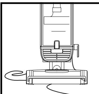
Para minimizar el riesgo de daño al cable de alimentación, NO pase la aspiradora sobre el cable de alimentación. Si esto ocurre, apague inmediatamente la aspiradora y libere el cable del cepillo giratorio o de la boquilla de piso.
