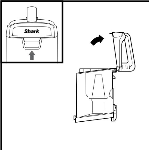
Afin de retirer les débris ramassés du **filtre à charpie**, soulevez la languette située au-dessus du récipient à poussière pour l'ouvrir. Retirez les débris du filtre à charpie pour le nettoyer.
