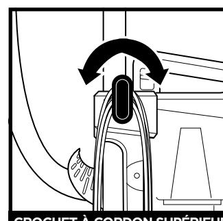
Pour accéder rapidement au cordon, faites pivoter le crochet supérieur vers le bas et retirez le cordon.
